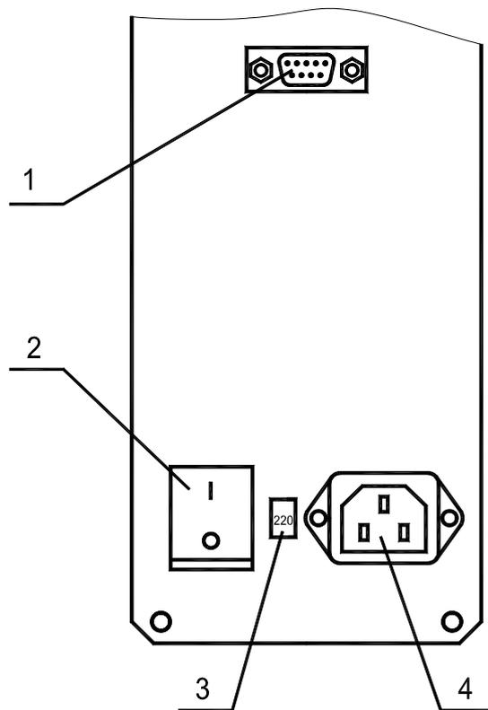
1-RS232 接口， 2-电源开关， 3-220V/110V 切换开关， 4-电源插座
