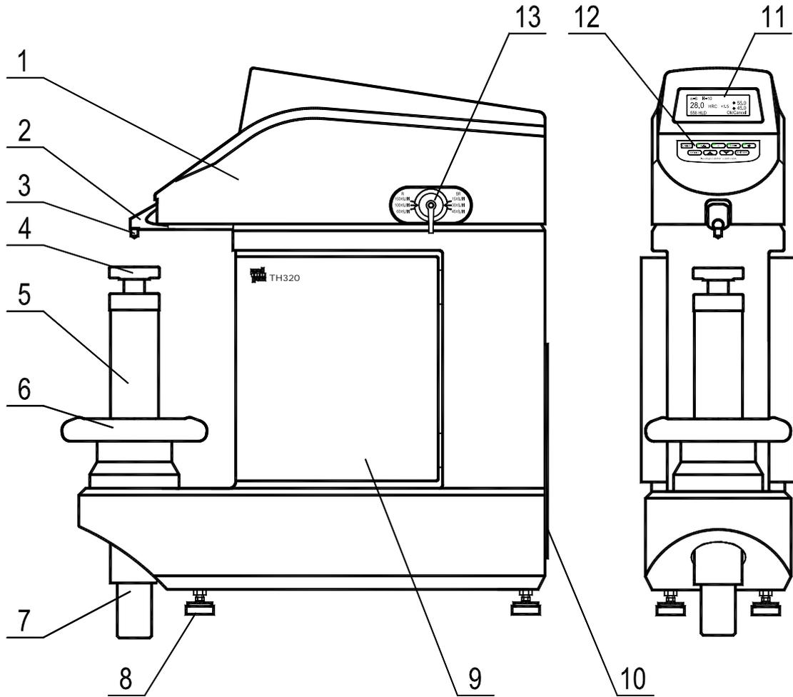
1-上盖 2-压头座 3-压头 4-样品台 5-丝杠护套 6-手轮 7-丝杠 8-底脚螺钉
